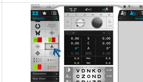
Esempio di test manuale dei cilindri crociati di Jackson
