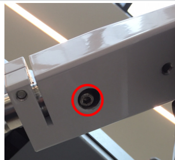
Винт М5 (расположен ниже)
